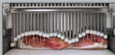
I piedini, suddivisi a sezioni, mantengono il prodotto fermo durante la fase di estrazione degli aghi.
