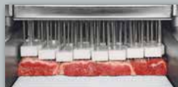
I piedini a pressione regolabile e divisi in sezioni, mantengono il prodotto fermo durante la fase di estrazione degli aghi.
